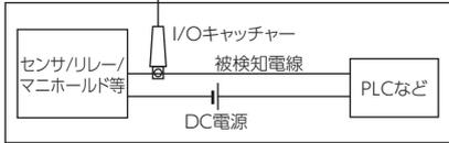
(\*) 1本をクランプするだけでは、検知電流が確実にONになる電流値を超えない場合は、被検知電線をターンして複数本をクランプしてください。
